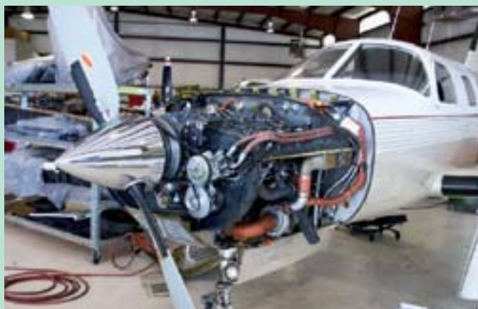
UMBAUPHASE: Der von Rocket Engineering leihweise überlassene Kolbenmotor wird in Spokane aus der Mirage ausgebaut.
